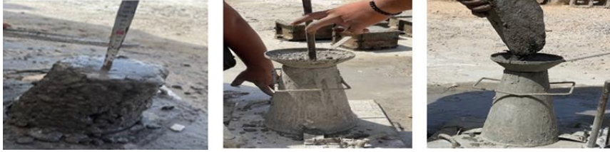
الشكل (9) طريقة اجراء اختبار الهبوط للخلطات الخرسانية الطازجة.
