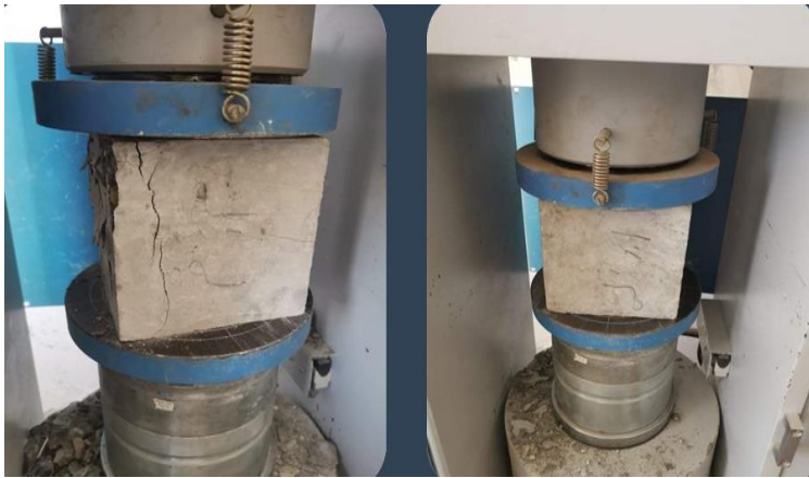
الشكل (12) طريقة اختبار مقاومة الضغط
