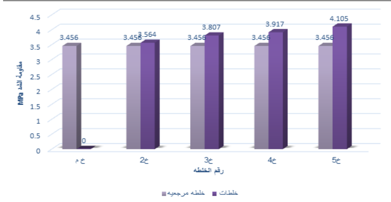
الشكل (17) نتائج اختبار مقاومة الشد بالمقارنة بالخلطة المرجعية
