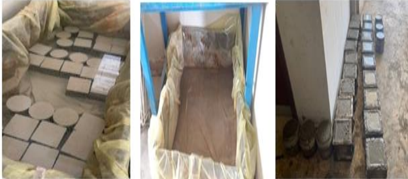
الشكل (8) العينات بعد صبها ومعالجتها.
