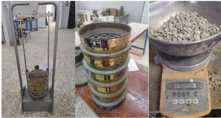
الشكل (2) اختبار التحليل المنخلي للركام الخشن
